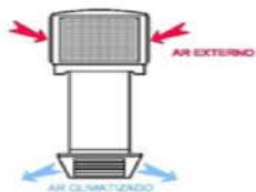
CROQUI DO SISTEMA DE RESFRIADOR (DIFUSOR 6 VIAS)
